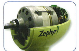
制御基板・新型発電機
